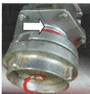
Obr. č. 3 a 4. Podhled na pravý a levý vývod z hlavního čerpadla, výtlačného potrubí pro ruční vedení, jsou mrazem popraskané
