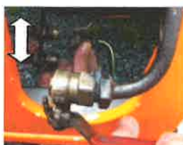
Obr. č. 2. Pohled na oba ventily sloužící k uzavírání Asanační lišty (tzv. kropící rampy) pod předním nárazníkem. Oba ventily jsou mrazem utržené.
