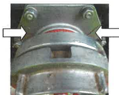
Obr. č. 3 a 4. Podhled na pravý a levý vývod z hlavního čerpadla, výtlačného potrubí pro ruční vedení, jsou mrazem popraskané
